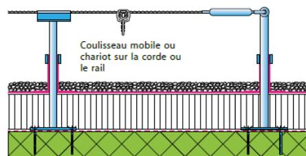
Fig. 14: Classe d'équipement 2: système horizontal permanent à corde surpassable avec tendeur ancré directement dans le béton armé
